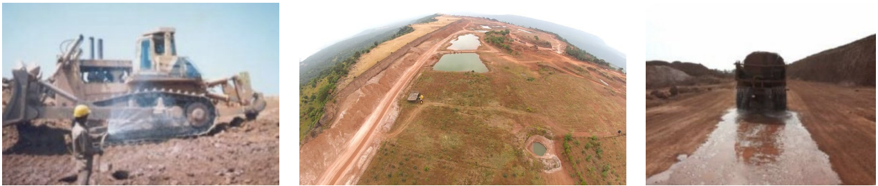
图 7.12 印度 Hindalco Durgmanwadi 所有作业阶段的粉尘抑制
